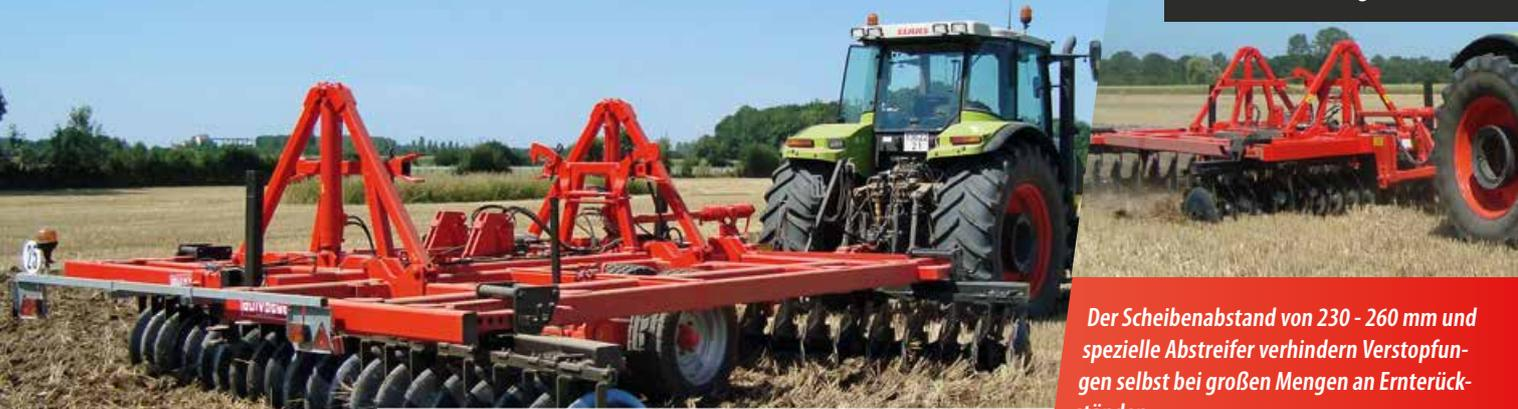
Der Scheibenabstand von 230 - 260 mm und spezielle Abstreifer verhindern Verstopfungen selbst bei großen Mengen an Ernterückständen.
