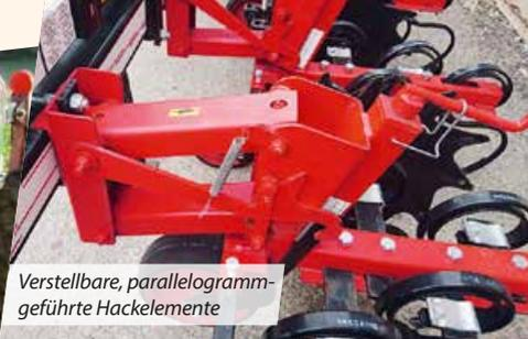
Verstellbare, parallelogrammgeführte Hackelelemente
