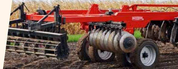
mit Flachstegwalze Ø 450 mm
