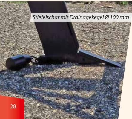
Stiefelschar mit Drainagekegel Ø 100 mm
