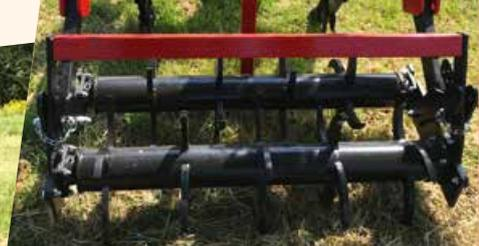
Doppel-Stachelwalze mit mechanischer Verstellung
