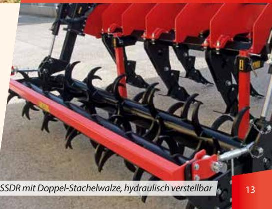
SSDR mit Doppel-Stachelwalze, hydraulisch verstellbar
