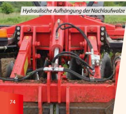
Hydraulische Aufhängung der Nachlaufwalze
