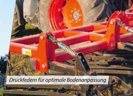
Druckfedern für optimale Boden Anpassung
