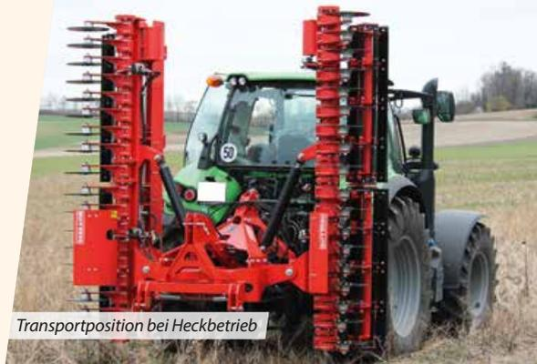
Transportposition bei Heckbetrieb
