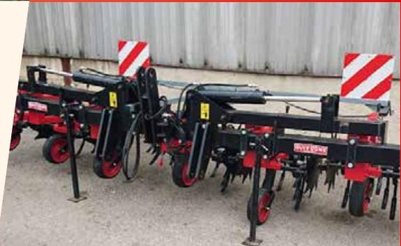
Hydraulisch klappbar, Abstellstützen
