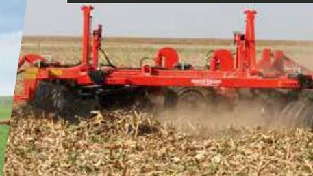
Der Scheibenabstand von 230 - 260 mm und spezielle Abstreifer verhindern Verstopfungen selbst bei großen Mengen an Ernterückständen.
