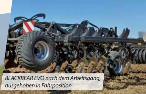
BLACKBEAR EVO nach dem Arbeitsgang, ausgehoben in Fahrposition
