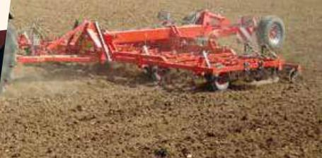
Der Federzinken-Kultivator VIBRO-CULTEUR VR NG eignet sich sowohl für die oberflächliche Stoppelbearbeitung, als auch für die Saatbettbereitung und die Bekämpfung von Unkraut.
