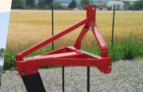
Der Untergrundlockerer S80 eignet sich besonders für die Ackerentwässerung und die Lockerung von Fahrgassen.
